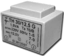
Малогабаритные трансформаторы для печатных плат серии ТН (G) предназначены для установки в устройствах электропитания оборудования. Трансформаторы этой серии герметизированы компаундом, характеризуются компактной конструкцией, обладают устойчивостью к механическим и климатическим воздействиям, соответствуют требованиям ДСТУ IEC 61558-2-1.
