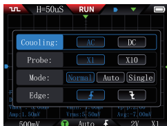
Oscilloscope Parameter Setting Interface
