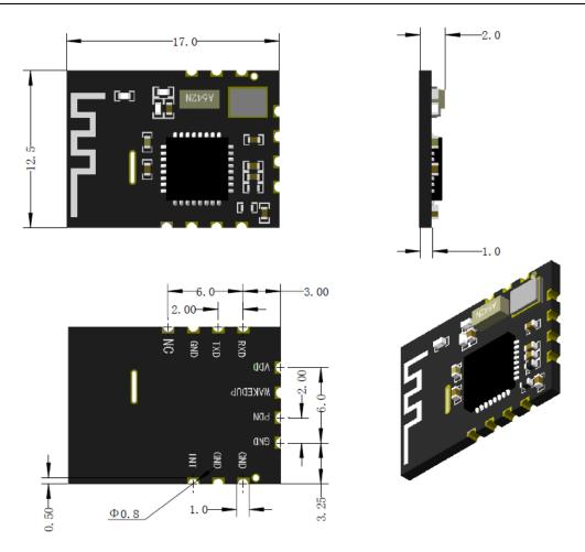
Fig5. HM-BT4502(A) Module Size Diagram
