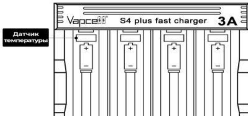
1. Если температура аккумулятора превышает  $65^{\circ}\text{C}$  и зарядный ток превышает 1500 мА (за исключением 1500 мА), он будет снижен до уровня 2, например, если ваш текущий зарядный ток составляет 3000 мА, он автоматически будет заряжаться при 2000 мА.
