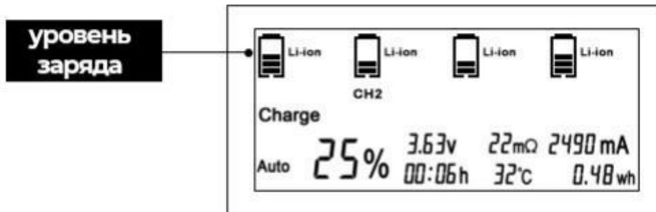
**2.7** Если в зарядном устройстве установлено сразу несколько аккумуляторов, нажмите кнопку DISPLAY несколько раз, чтобы поочередно отображать данные каждого слота. Каждый слот независим от других, без взаимного влияния друг на друга. Если отображается CH1, это будут данные батареи первого слота.
