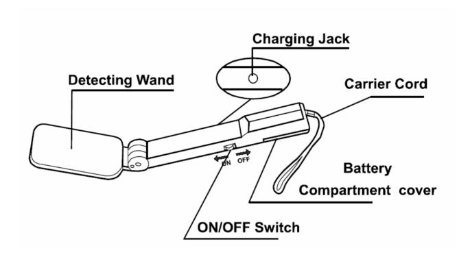
Charging Jack - Разъем для подзарядки батарейки-аккумулятора Detecting Wand - Конец с датчиком-детектором Carrier Cord - Лямка для ношения устройства на запястье Battery Compartment cover - Крышка блока питания On/off switch - Выключатель («ВКЛ» и «ВЫКЛ»)
