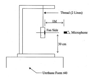
1 METER FROM MICROPHONE TO FAN INTAKE
